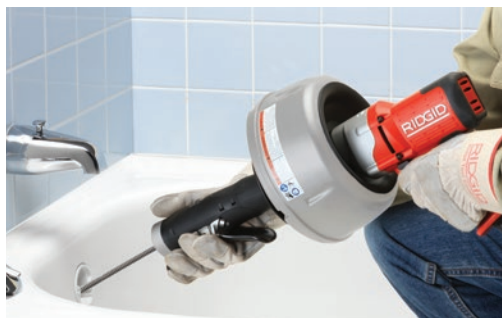
Модель K-45AF быстро пробивает забитые трубопроводы ванн. Подает и извлекает спираль без реверсирования двигателя
